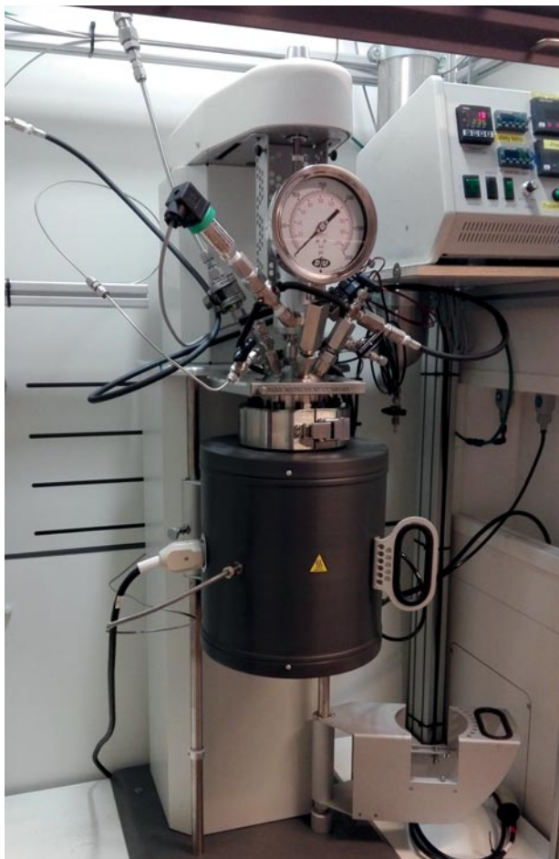
▲ Reactor voor omzetting van ruwe biomassa naar bruikbare platformmoleculen
